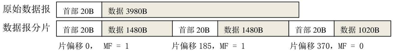
**知识点：**第 4 章 网络层——4.2 网际协议 IP——4.2.5 IP 数据报的格式
